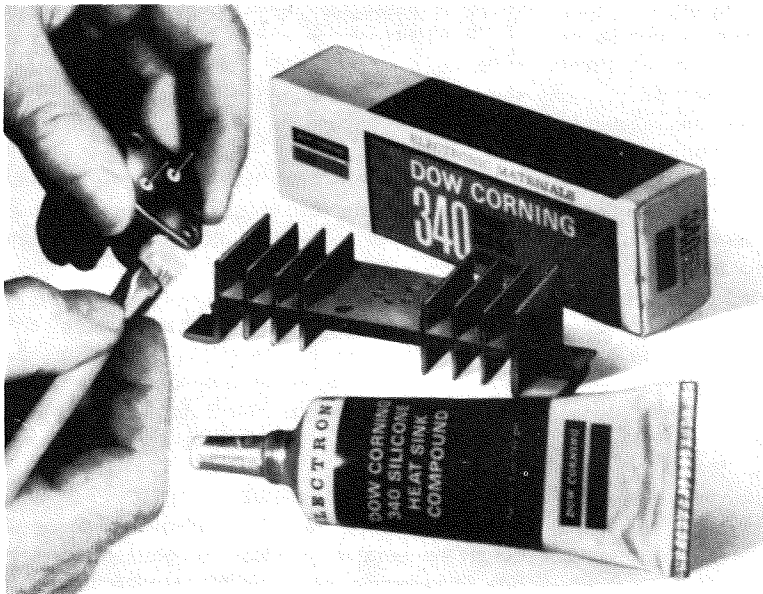
Fig. 18 Se nel vostro montaggio è assolutamente necessario impiegare una mica isolante, cercate di ridurre questa resistenza termica spalmando tra transistor e mica e tra mica ed aletta della pasta al silicone. Nella tabella n. 2 a fine articolo viene indicata la resistenza termica Rcd che presenta un contenitore usando o meno la pasta al silicone.
